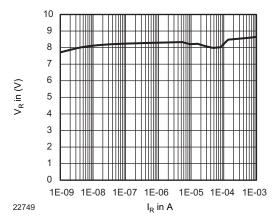
Fig. 3 - Typical Reverse Voltage  $V_{\mathsf{R}}$  vs. Reverse Current  $I_{\mathsf{R}}$
