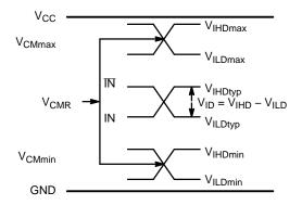
Figure 9. V<sub>CMR</sub> Diagram
