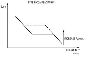
Figure 29. R<sub>COMP</sub> Adjust
