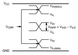
Figure 23. V<sub>CMR</sub> Diagram
