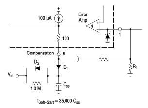
Figure 18. Soft-Start Circuit
