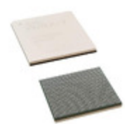
XC6VLX195T-2FF1156I AMD IC FPGA 600 I/O 1156FCBGA
