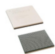
XC6VLX195T-2FFG1156I AMD IC FPGA 600 I/O 1156FCBGA
