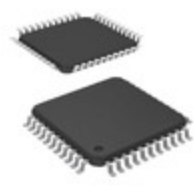
EPM3064ATI44-10 Intel IC CPLD 64MC 10NS 44TQFP
