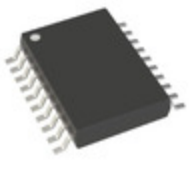
AD5144ABRUZ100 Analog Devices Inc. IC DGT POT 100KOHM 256TP 20TSSOP
